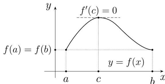
Рис. 2. геометрический смысл теоремы Ролля
