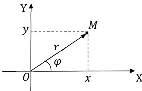
Рис. 6. Связь между декартовыми и полярными координатами
