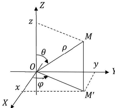
Рис. 8. Сферическая система координат
