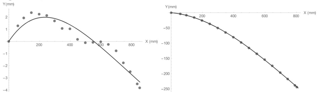
Рис.1 Теоретические и экспериментальные кривые прогиба стержня, полученные с использованием формулы 4 для массы груза  $m_1 = 0$  слева и  $m_2 = 1500$  грамм справа.
